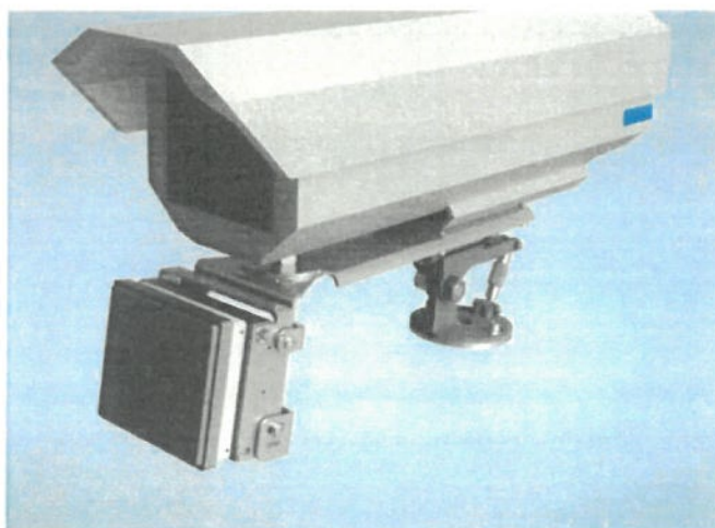
Obr. 8 Držák kamery včetně radarového senzoru mechanicky zabraňující záměně kamer a senzoru (modře je označeno místo pro zajišťovací značku výrobce)
